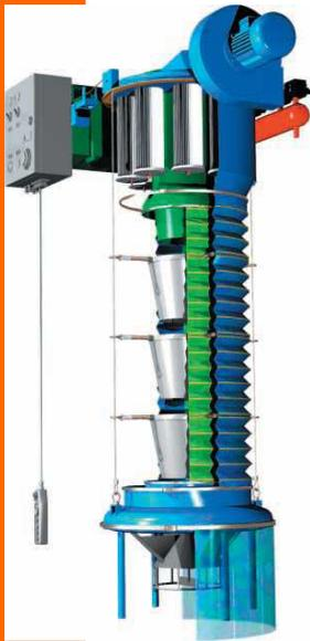
Los descargadores telescópicos ZC se utilizan para descargar materiales en o granulares secos de manera eficiente y controlada en los camiones abiertos. Los descargadores tienen conos internos para canalizar el flujo de material y de un doble fuelle para la extracción de polvo.
